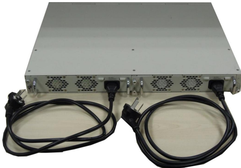
图 4-15 连接可插拔交流电源线缆
